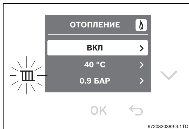
Рис. 10 Меню температуры котла
